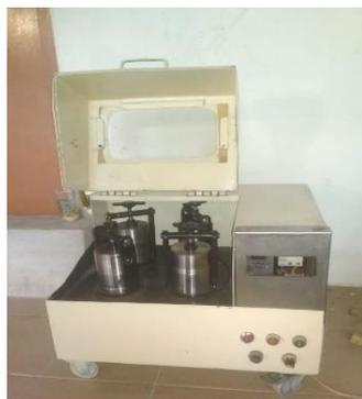
Bagian-bagian pada Planetary Ball Milling:
